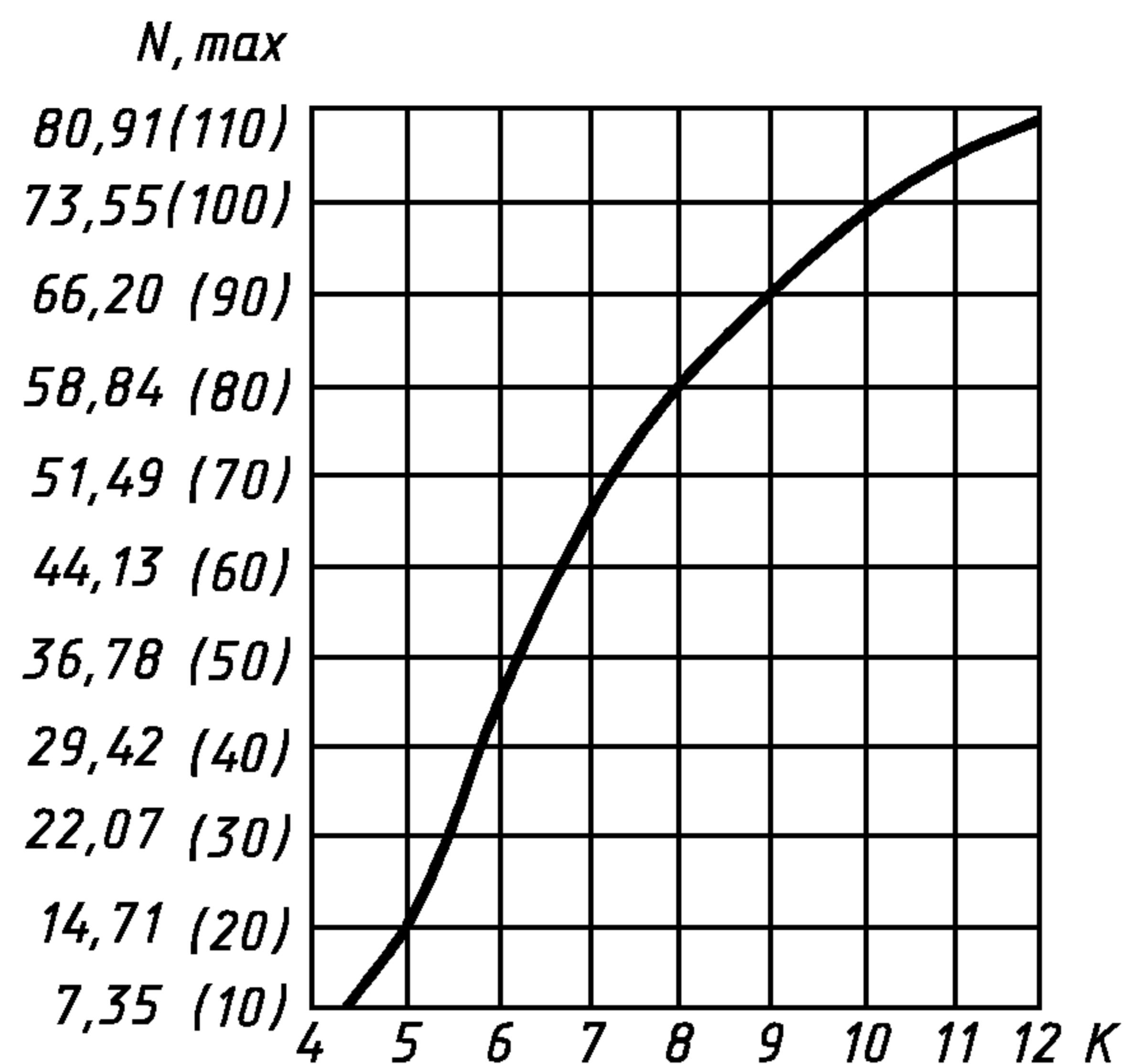
$N_{max}$  — максимально допустимая мощность подвесных моторов и стационарных двигателей, кВт (л. с);  $K$  — коэффициент, определенный по формуле настоящего стандарта.
